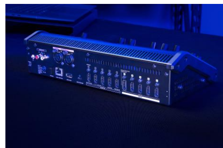
小型ながら 4K/60p 対応、 各 5 系統の HDMI 入出力端子を装備
